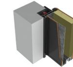
**B-** Premarco metálico con pletina cubierto de obra para exterior.
