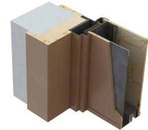
**D –** Premarco metálico con pletina cubierto con tapeta metálica.
